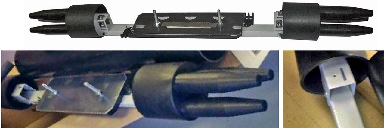
Следует отметить, что в муфтах такой конструкции (с жёстко связанными металлическим лотком оголовниками) при температурах ниже  $-40^{\circ}\text{C}$  происходит неизбежная разгерметизация из-за разницы в коэффициенте расширения металла и пластика.
